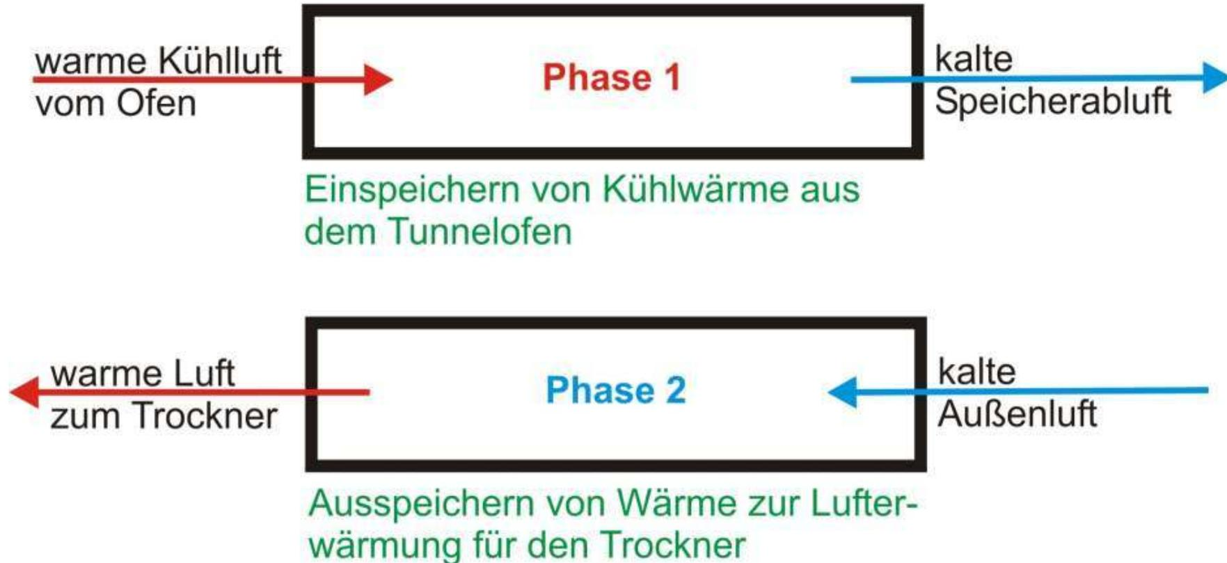
Zeitliche Entkopplung von Ofen und Trockner durch die Installation eines regenerativen, mit Ziegeln im Gitterbesatz gefüllten Kanalwärmespeichers
